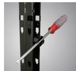
프레임 커넥터 커넥터를 이용, e-플랜맥스만의 독특한 체결방식이 이루어 집니다. 고강도의 플라스틱 사출로 만들어진 커넥터는 특별한 공구 없이도 가장 빠른 시간 내에 시스템 구축을 가능케 합니다.
